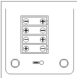
**RESET :** Interferenze elettromagnetiche o scariche elettrostatiche possono provocare malfunzionamenti alla visualizzazione oppure alterazioni o perdite del contenuto della memoria. Se dovesse accadere ciò, utilizzare la punta di una penna a sfera (o altro oggetto appuntito) per premere il tasto [RESET] sul retro della calcolatrice. Una volta riazzzerata la calcolatrice, assicurarsi di ripristinare la data, l'ora e l'aliquota d'imposta.
